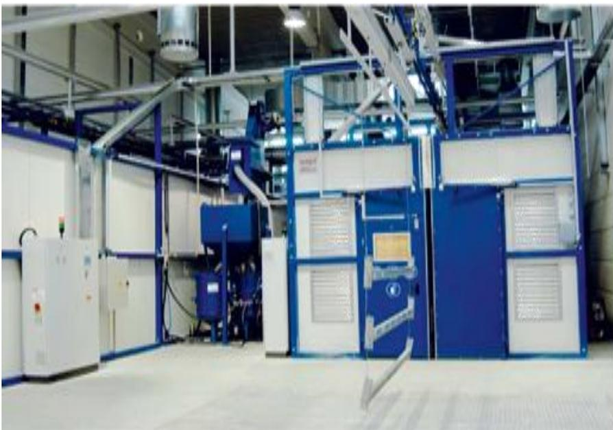
***Dve otryskávacie haly riadené systémom SPS na odstraňovanie pozinkovaných náterov a na tradičné pieskovanie. Haly sú vybavené automatickými dverami a s dopravníkom na otryskávanie kovových častí***
