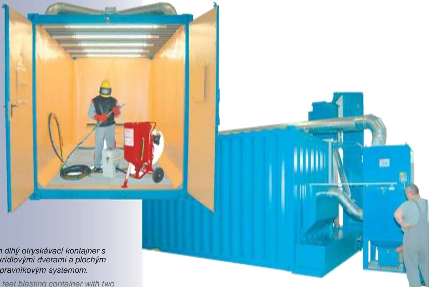
*6m dlhý otryskávací kontajner s 2-krídlými dverami a plochým dopravníkovým systémom.*
